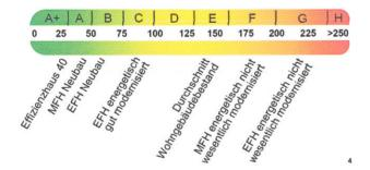
Die modellhaft ermittelten Vergleichswerte beziehen sich auf Gebäude, in denen Wärme für Heizung und Warmwasser durch Heizkessel im Gebäude bereitgestellt wird
